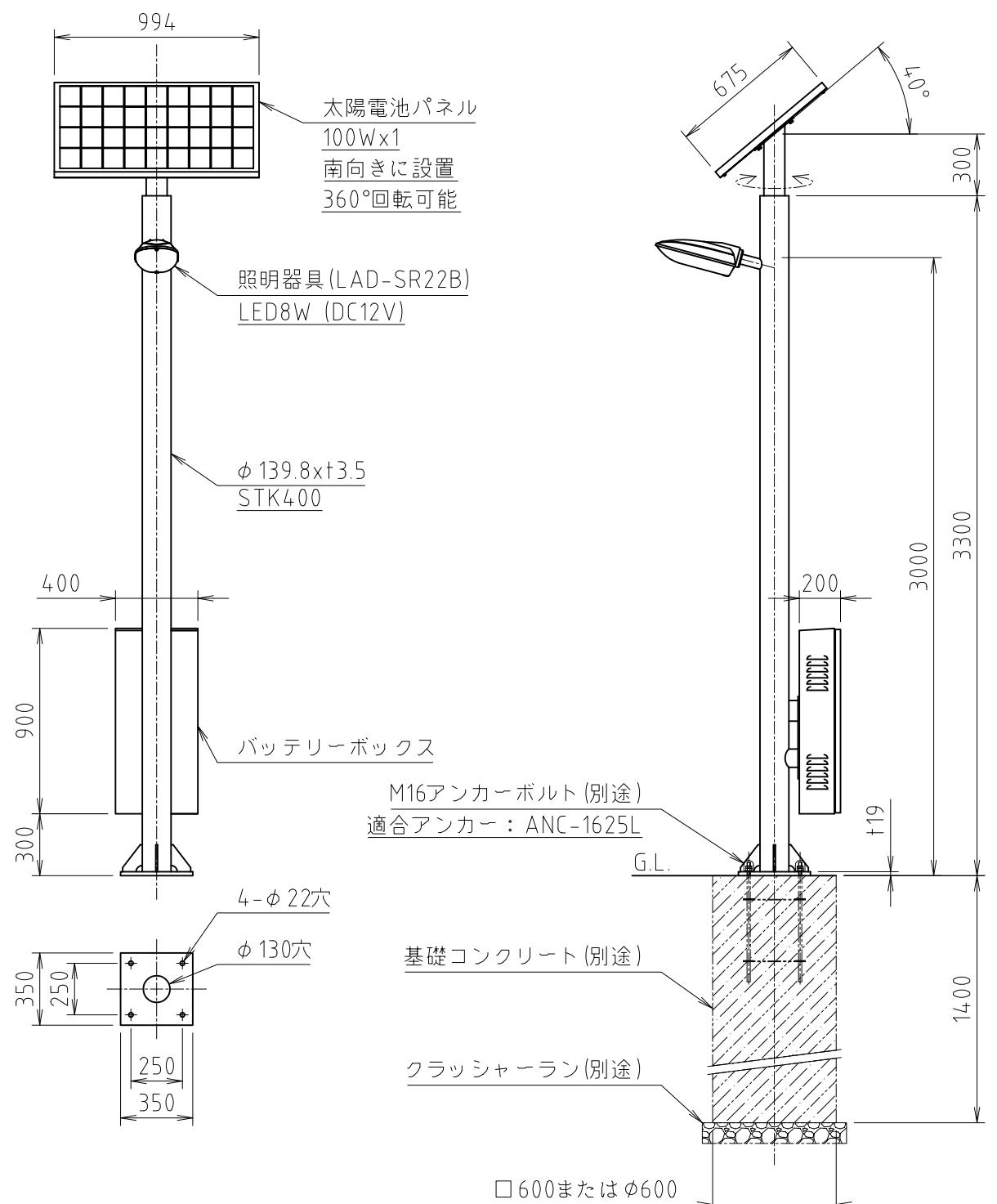
※基礎コンクリート寸法は参考値です。基礎表面は必ず地表に出し、傾斜をつけ雨水等が溜まらないように工事を行って下さい。
