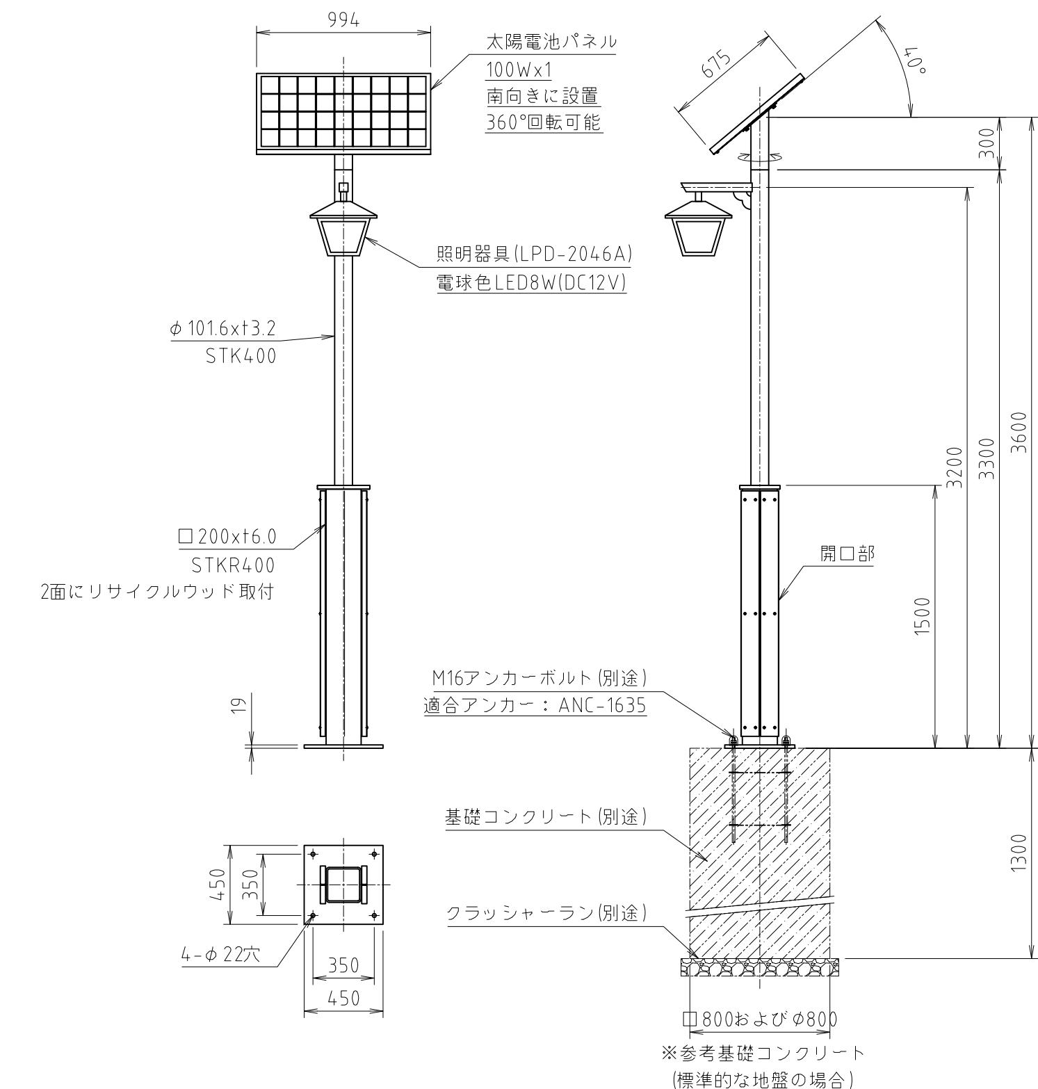
※基礎コンクリート寸法は参考値です。基礎表面は必ず地表に出し、傾斜をつけ雨水等が溜まらないように工事を行って下さい。
